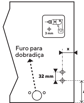
Furações da porta Vista interna
